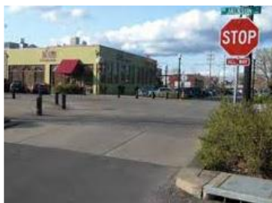
Figure 6.52: Carrefour surélevé avec un panneau stop.
