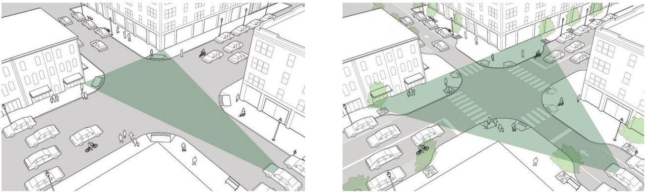
Figure 3.18: Exemples de triangles de visibilité du conducteur aux carrefours
