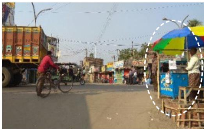
Figure 6.4: Obstacles au triangle de visibilité sur une route secondaire à un carrefour en T.
