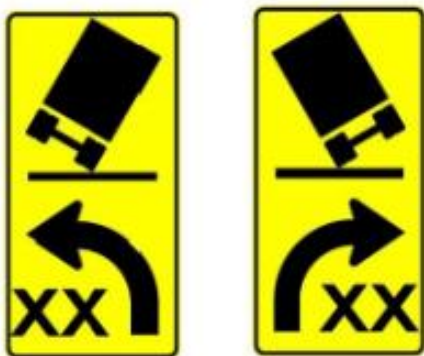
Figure 6.55: Panneaux d'avertissement de basculement de camion avec vitesse conseillée.
