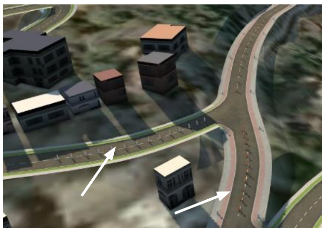
Figure 5.52: Bornes souples améliorant la visibilité du terre-plein central au carrefour.
