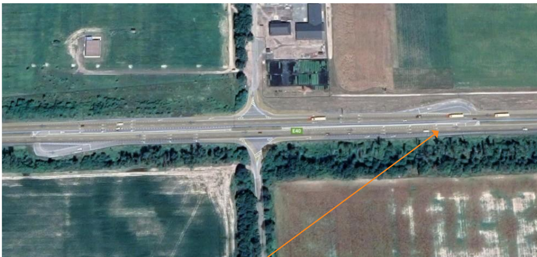
Figure 6.74: Carrefour RIRO avec virage à droite trop rapproché en Ukraine.
