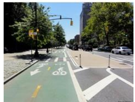
Figure 6.66: Traitement des routes secondaires avec des poteaux souples.
