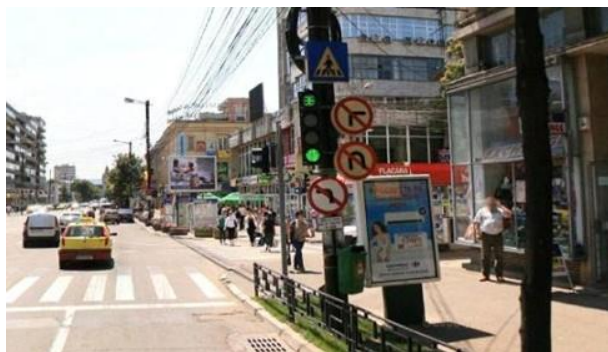
Figure 5.162: La surutilisation des panneaux est une source de distraction.
