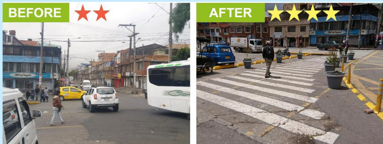
Figure 6.14: Mise en place de mesures d'interdiction de circuler et de protection des piétons en Colombie.
