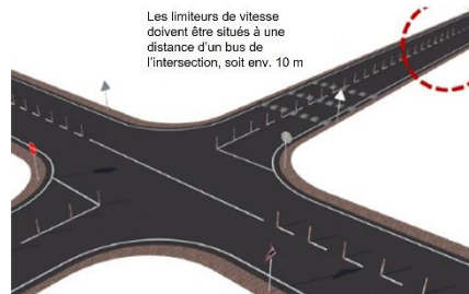
Figure 6.65: Traitement des routes secondaires avec des poteaux souples.
