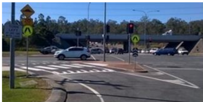
Figure 6.69: Passage piéton surélevé sur la voie d'accès avec marquage d'îlots fantômes et panneaux de signalisation de passage piéton.
