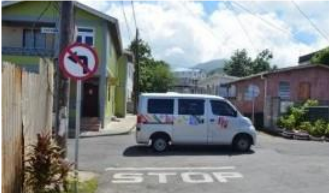
Figure 6.8: Panneau d'interdiction de tourner à gauche avec marquage d'arrêt à un carrefour sans feux de signalisation en Dominique.
