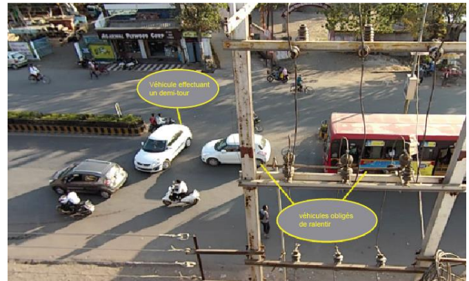
Figure 5.109: Véhicule faisant demi-tour et empiétant sur l'espace routier pour le trafic en approche.
