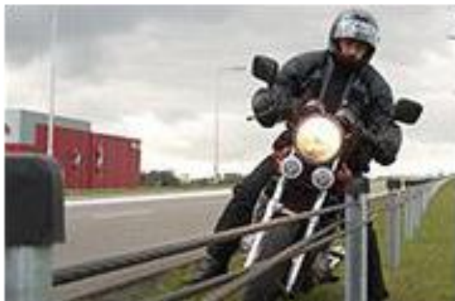
Figure 4.52: Impact d'une moto avec une barrière en câble métallique.
