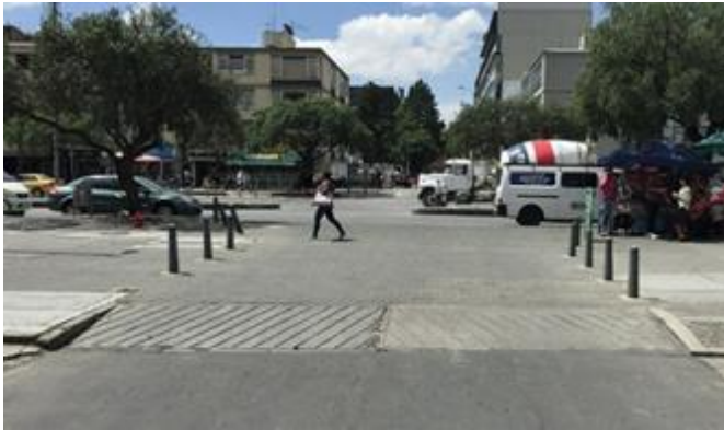
Figure 6.48: Carrefour surélevé à Bogota pour donner la priorité aux piétons sur une artère.
