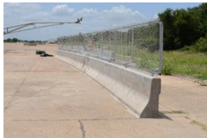
Figure 4.56: Poteaux modifiés en forme de U et fixés à une glissière en béton incurvée
