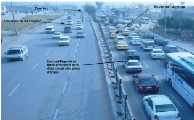
Figure 5.108: Demi-tour sur un terre-plein central étroit (avec voie d'attente).
