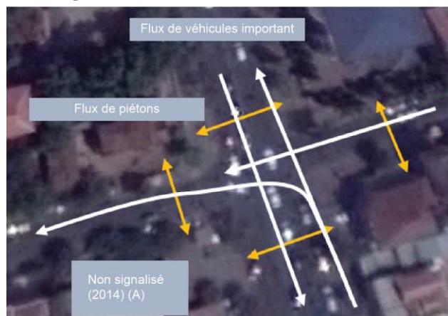
Figure 6.29: Flux de trafic à un carrefour sans feux de signalisation et sans passage piétons à Phnom Penh, Cambodge.
