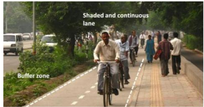
Figure 3.41: Aménagements pour cyclistes et piétons avec zone tampon.
