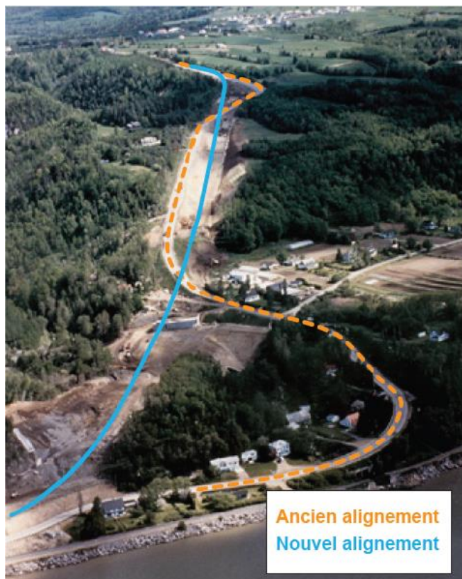
Figure 5.53: Modification de l'alignement pour éliminer une courbe prononcée au bas d'une pente raide.
