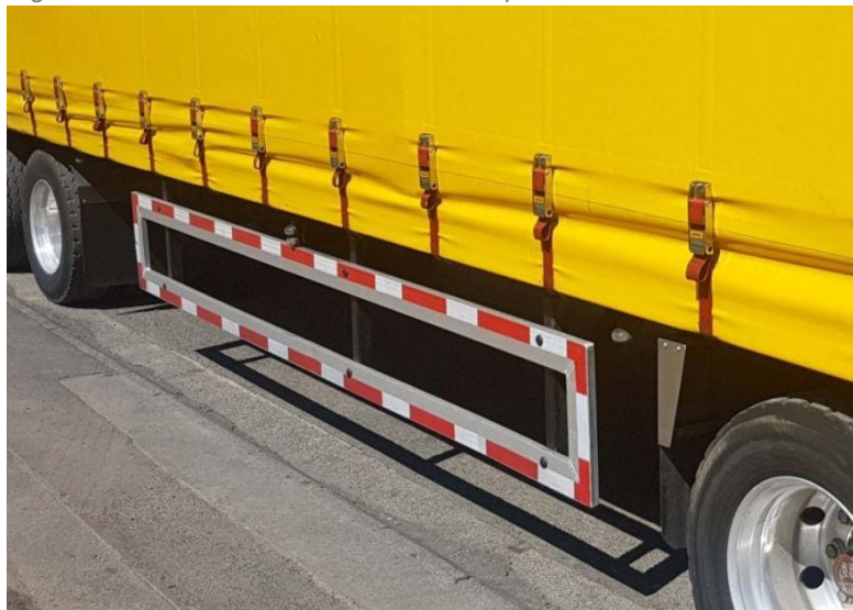
Figura A.22: Protecciones laterales antiempotramiento en camión.
