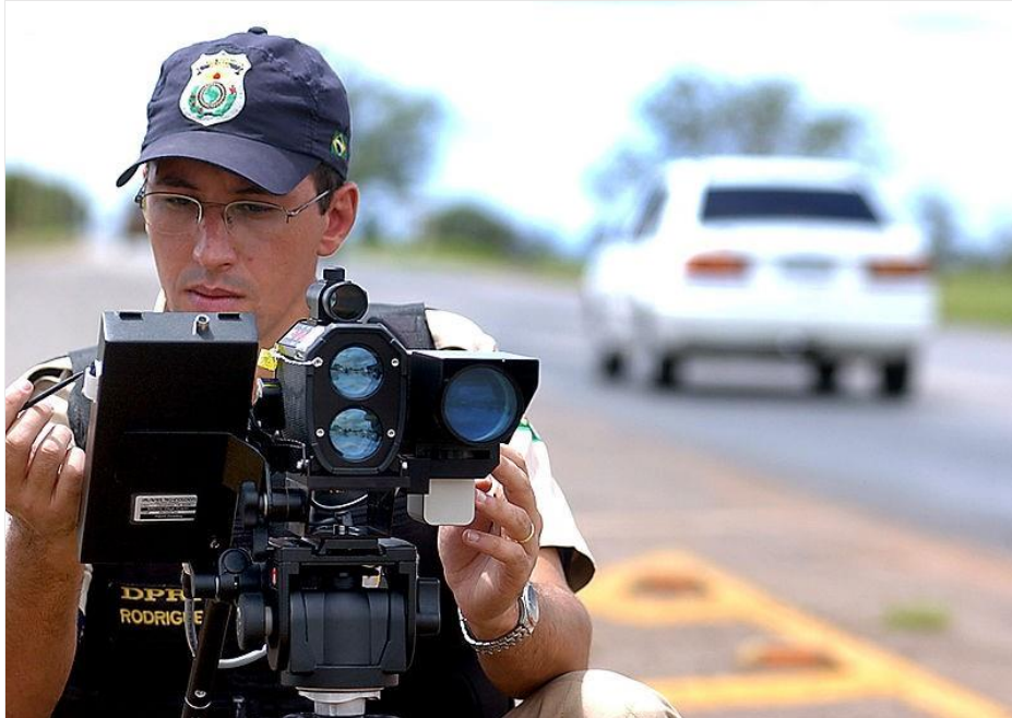
Figura A.19: Radar de tráfico móvil en carretera
