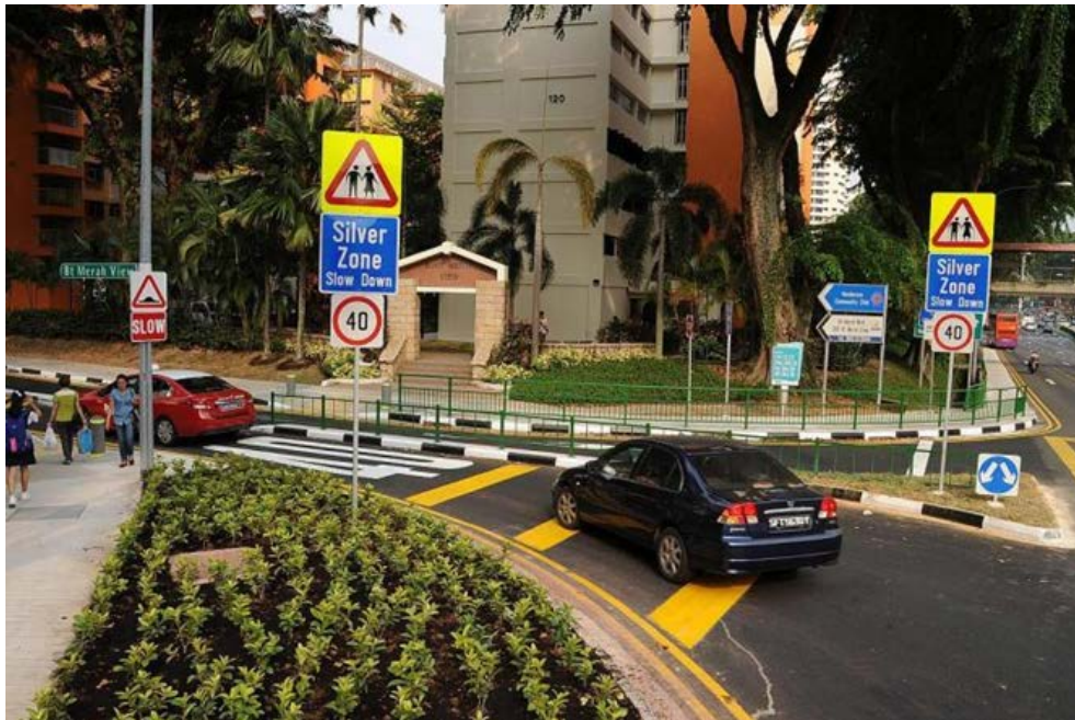
Foto 3.2. Tanda Zona Perak dan Rumble Strip, Bukit Merah View
