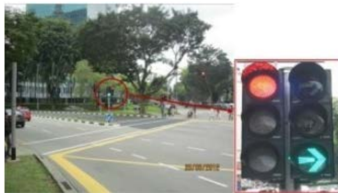
Foto 5.1. Belokan Kanan yang Sepenuhnya Terkendali (panah merah-kuning-hijau)
