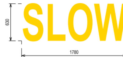
TANDA SLOW SKALA 1:30 KODE WARNA: RAL 1003 (KUNING) RAL 3011 (MERAH) KATA "SLOW" MENGGUNAKAN FONT HELVETICA / HELVETICA BOLD CATATAN: MARKAH WARNA KUNING PADA AKHIRAN JALUR WARNA MERAH. MARKAH WARNA MERAH PADA AKHIRAN LAINNYA
