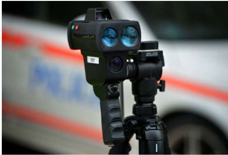
รูปที่ 3.6 ปืนตรวจจับความเร็วสำหรับตำรวจ
