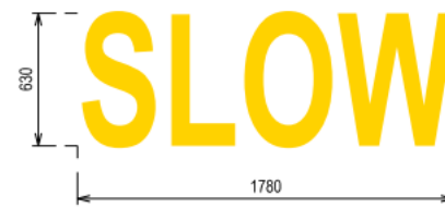
LOGO ĐI CHẬM TỶ LỆ 1:30 MÃ MÀU: RAL 1003 (VÀNG) RAL 3011 (ĐỎ) CHỮ “SLOW” DÙNG FONT HELVETICA / HELVETICA BOLD GHI CHÚ: KÝ HIỆU MÀU VÀNG TRÊN MẶT ĐƯỜNG MÀU ĐỎ. KÝ HIỆU MÀU ĐỎ TRÊN CÁC MẶT ĐƯỜNG MÀU KHÁC.
