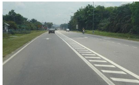
Figura A.5: Hachura central/canteiro pintado. (Fonte: iRAP)
