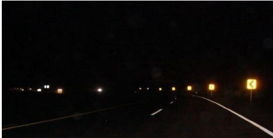
Figura A.10: Exemplo de placase/ou sinalização horizontal Marcadores de alinhamento retrorrefletivos que proporcionam visibilidade à noite. (Fonte: iRAP)
