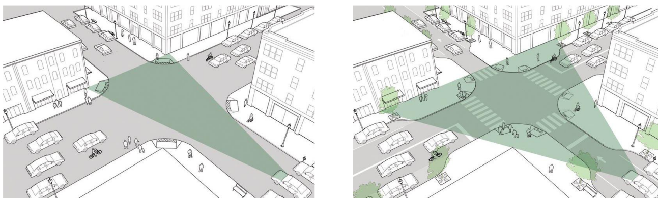
Figura 3.18: Exemplos de triângulos de visibilidade dos condutores nos cruzamentos
