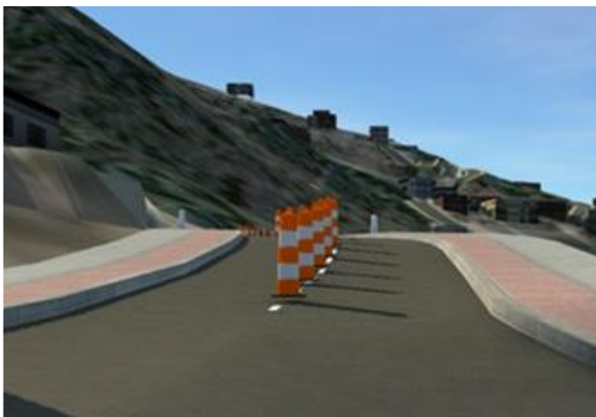
Figura 5.51: Colocação de cones flexíveis em curvas com campo de visão limitado.
