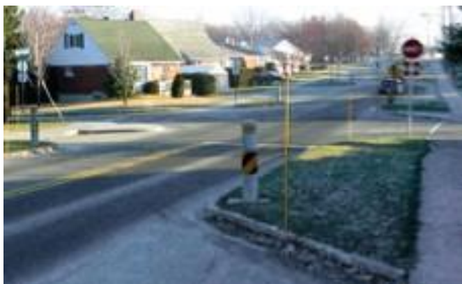
Figura 6.6: Sinais de “Pare” e medidas para desaceleração do tráfego, em cruzamentos não sinalizados.
