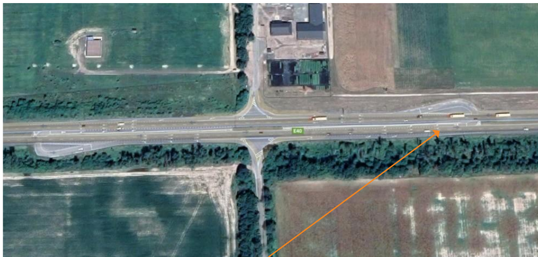
Figura 6.74: Interseção RIRO com curva à direita muito próxima na Ucrânia.
