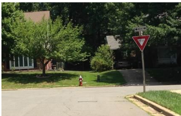
Figura 6.3: Sinais de cessão de preferência para travessias usados para controlar cruzamentos.
