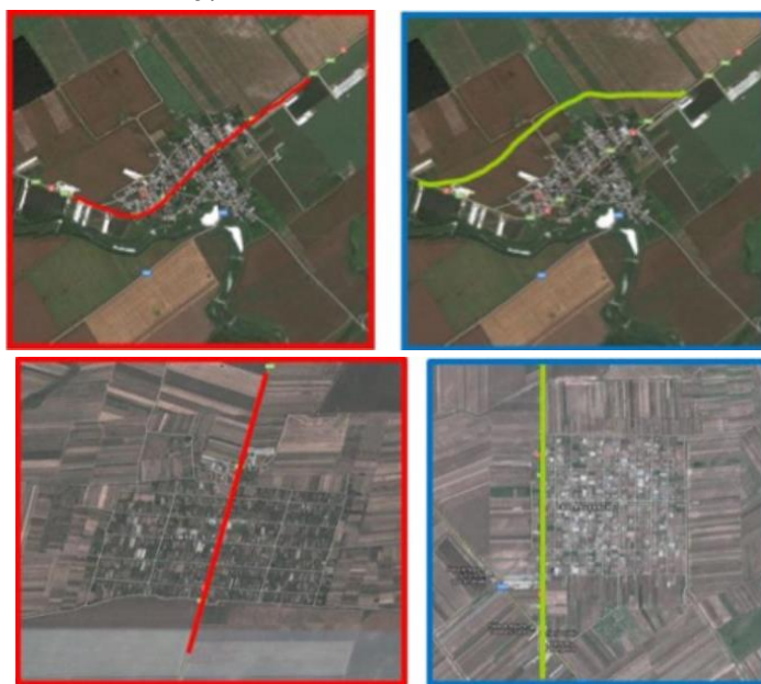
Figura 3.29: Exemplos de vias secundárias (bypass roads).
