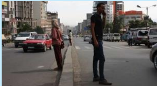
Figura 5.117: Mediana estreita e insegura.
