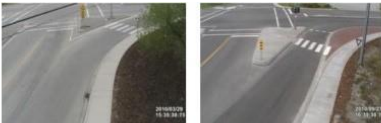
Figura 6.60: Ângulo da faixa de rolamento transformado de largo (imagem à esquerda) para apertado (imagem à direita).
