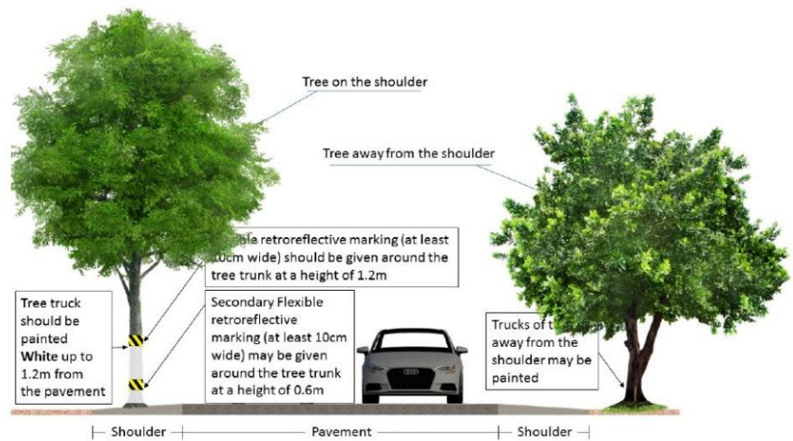
Figura 5.79: Ilustração do delineamento de árvores como último recurso de intervenção possível. Método pode ser utilizado em combinação com outras intervenções, incluindo redução de velocidade e proteção por barreiras de segurança.
