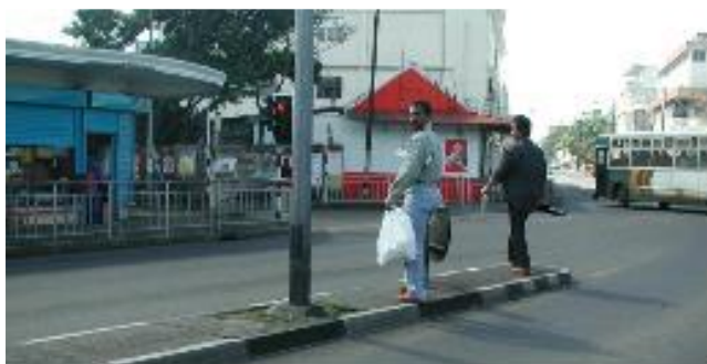
Figura 4.25: Falta de espaço para pedestres no canteiro central- Ilhas Maurício.
