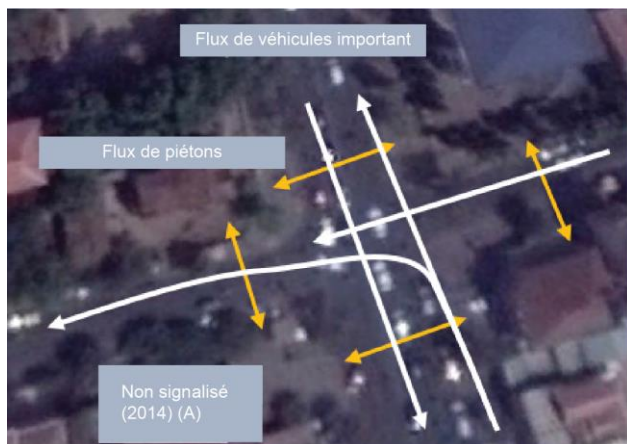
Figura 6.29: Fluxos de tráfego em cruzamentos não sinalizados e sem travessias para pedestres em Phnom Penh, Camboja.
