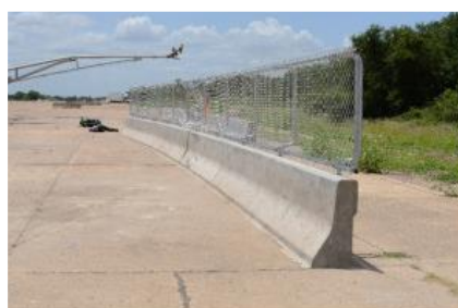
Figura 4.56: Postes em forma de U modificados e fixados a uma barreira curva de concreto
