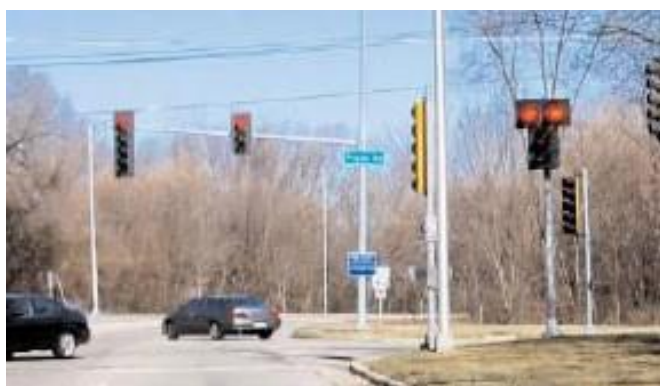
Figura 6.25: Sinal suplementar para cruzamento no meio de uma curva reversa.
