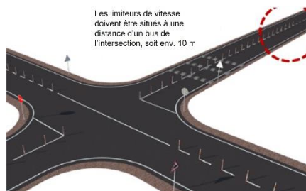
Figura 6.65: Intervenção em estradas secundárias usando postes flexíveis.
