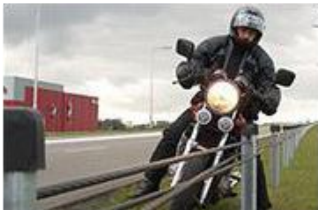
Figura 4.52: Impacto de motociclista com barreira de cabo de aço.
