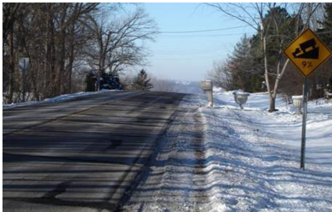
Figura 5.48: Um sinal de alerta de declive acentuado ao longo de uma via que aparenta ser menor visto à distância.
