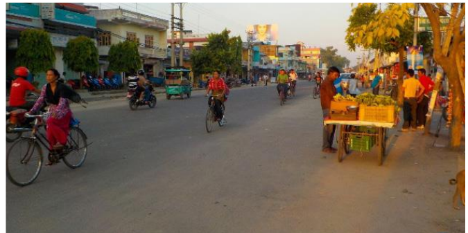
Figura 2.8: Barracas na via sem separação entre movimentos de tráfego de alta velocidade e área de atividade mista – Nepal
