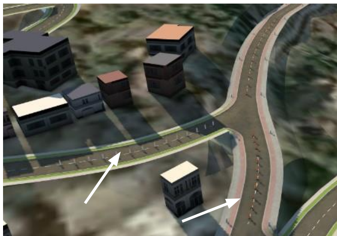
Figura 5.52: Postes flexíveis que melhoram a visibilidade do canteiro central na interseção.
